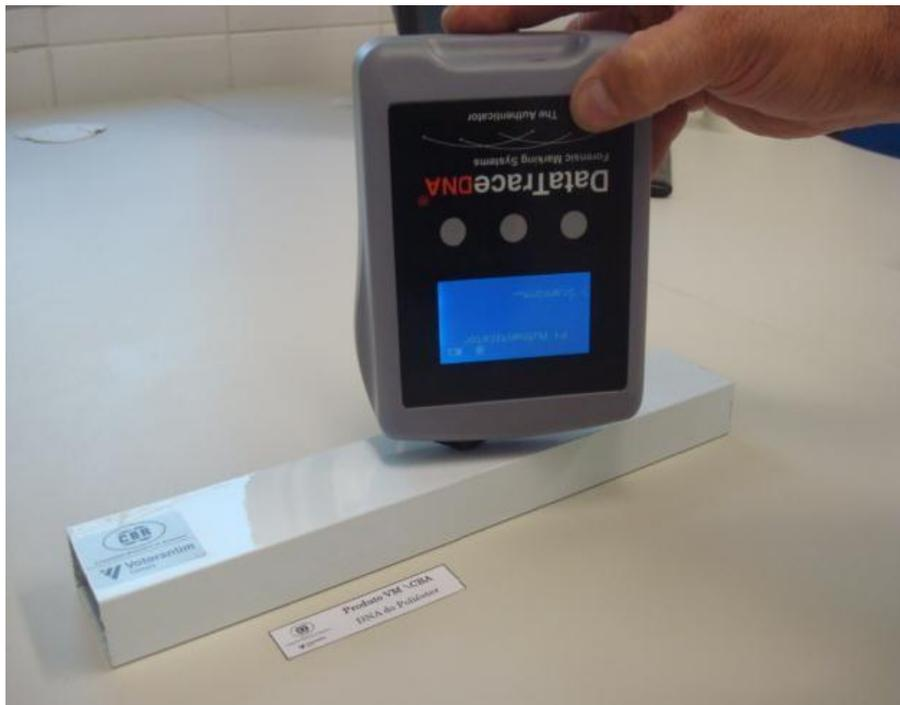
Figuras 6: Detecção do poliéster com o DNA
