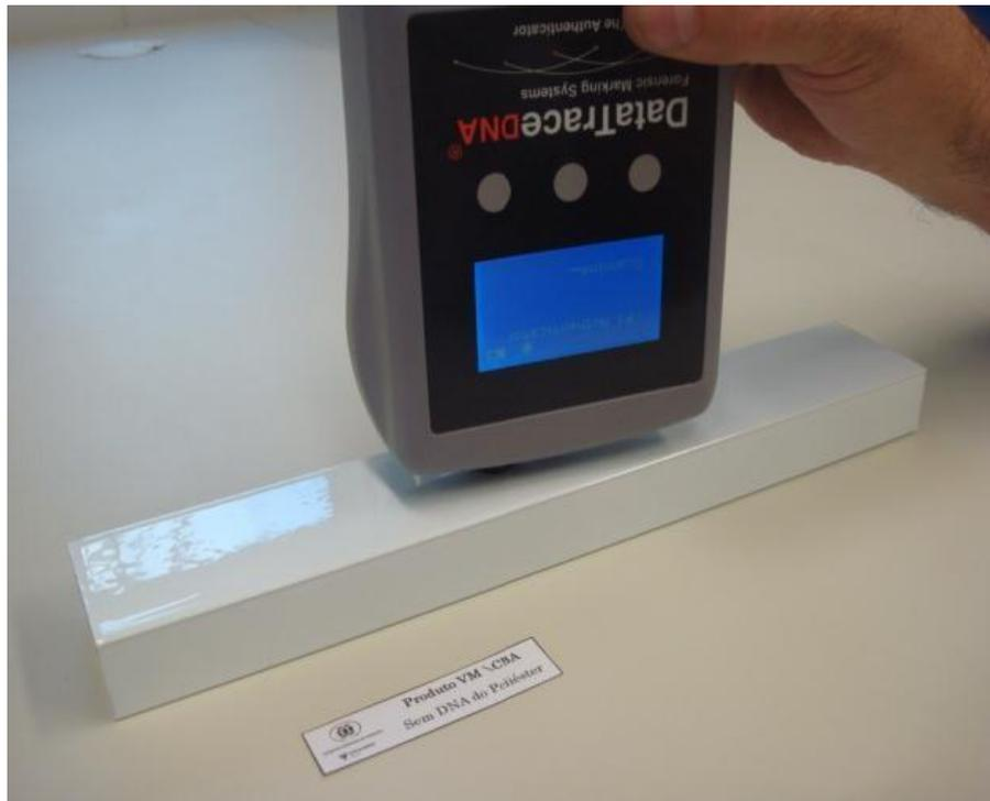
Figura 7: Detecção do Poliéster sem o DNA
