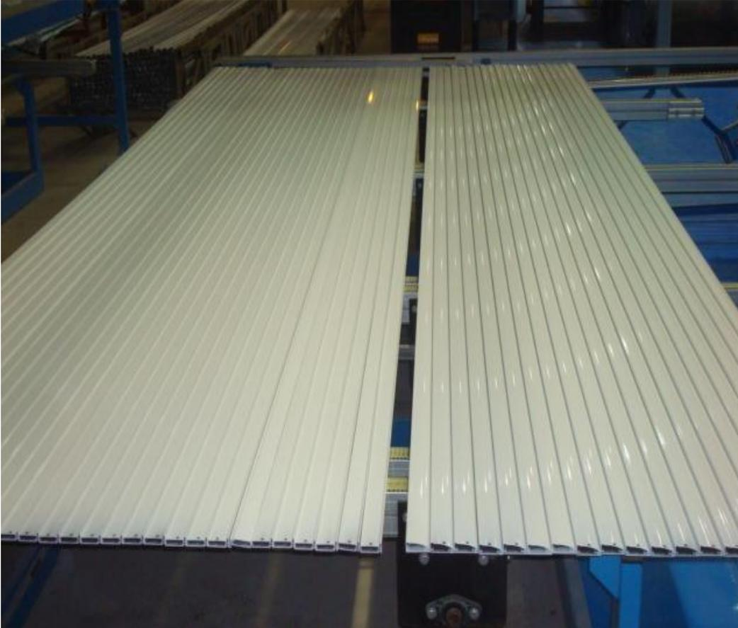
Figura 2: produto pintado na etapa final de processamento na unidade de pintura da VM/CBA.
