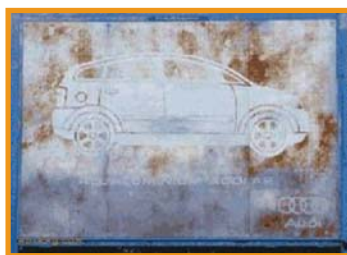
Foto 2 - Fortes sinais de corrosão após um mês em exposição ao meio ambiente
