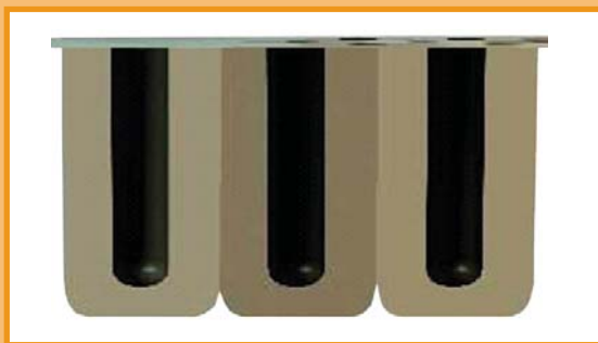
Figura 1 – Estrutura do filme anódico não-selado
